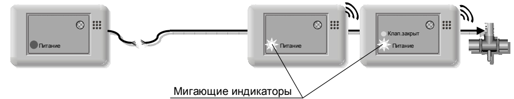
Рисунок 3 – Реакция Системы на обрыв кабеля
