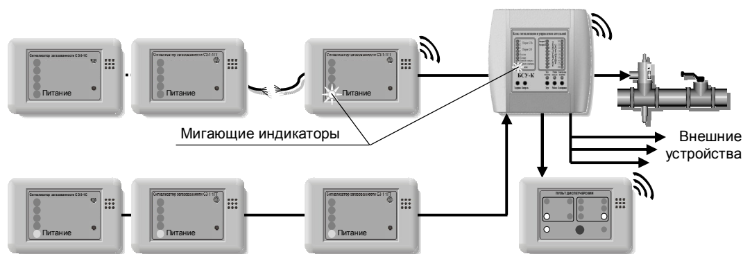
Рисунок 3 – Реакция Системы на обрыв кабеля/неисправность сигнализатора
