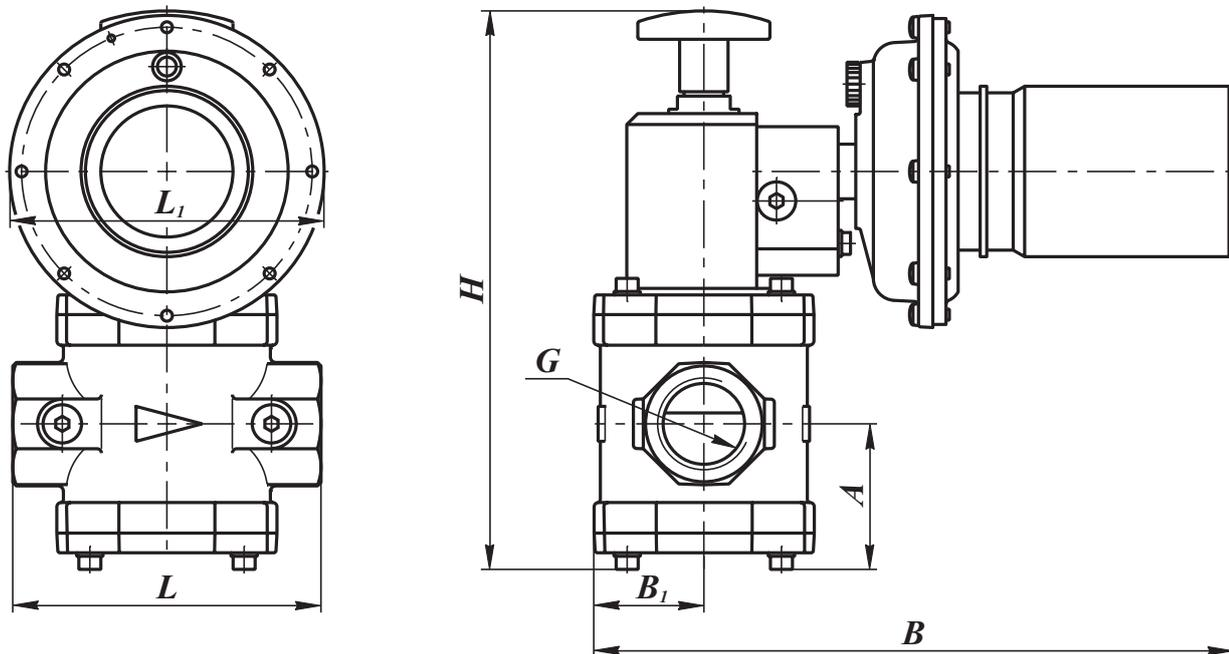
Габаритные и присоединительные размеры предохранительно-запорных клапанов муфтового исполнения
