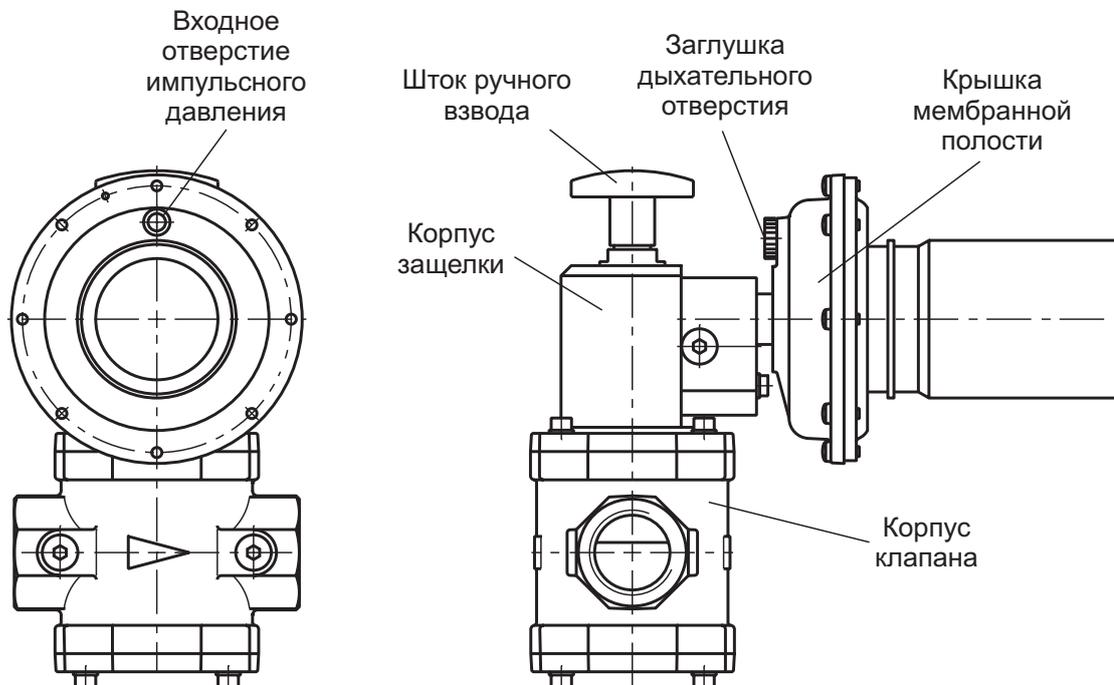
Для открытия клапана необходимо поднять шток ручного взвода вверх до упора для фиксации клапана в открытом состоянии. Импульсное (контролируемое) давление, снимаемое за регулятором давления, подается в мембранную полость. При превышении величины установленного давления клапан закрывается и перекрывает подачу газа в трубопроводе.
