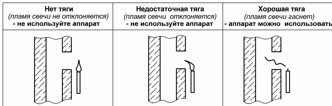
Рисунок 4. Способ проверки тяги в дымоходе
