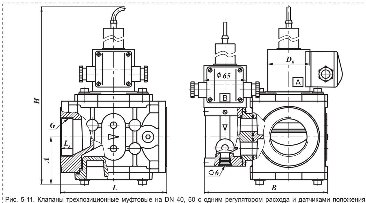
Рис. 5-11. Клапаны трехпозиционные муфтовые на DN 40, 50 с одним регулятором расхода и датчиками положения
