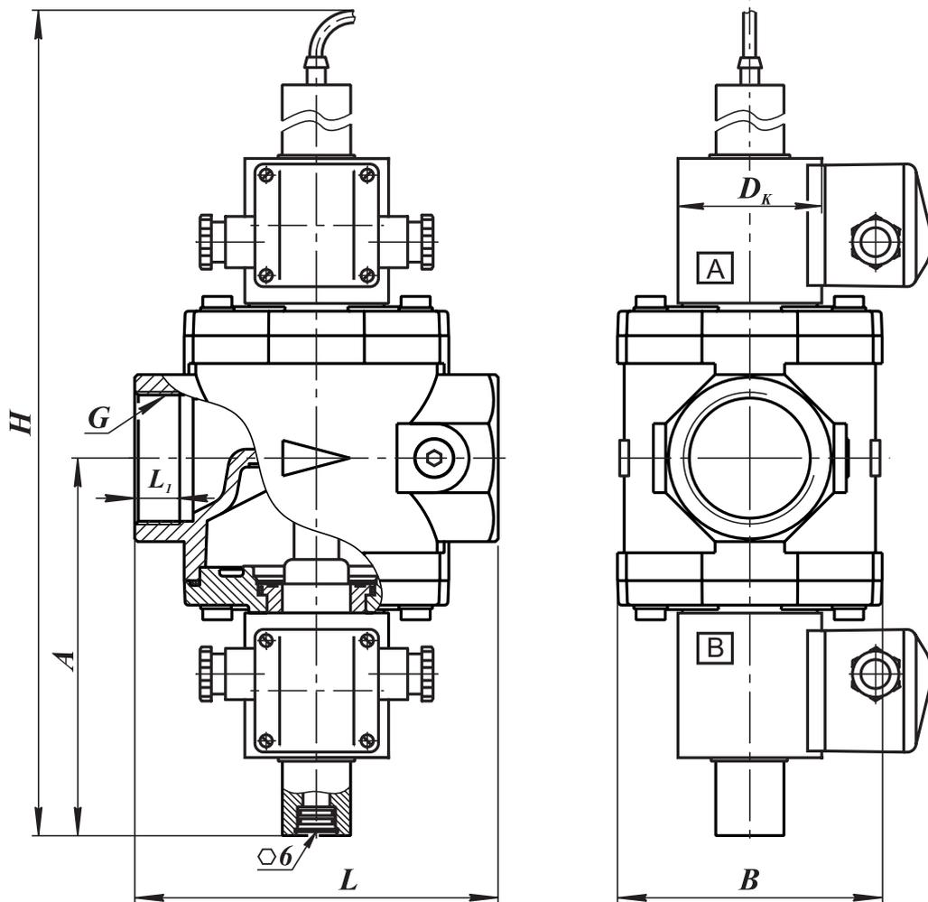
Рис. 5-4. Клапаны трехпозиционные муфтовые на DN 40, 50 с одним регулятором расхода и датчиком положения
