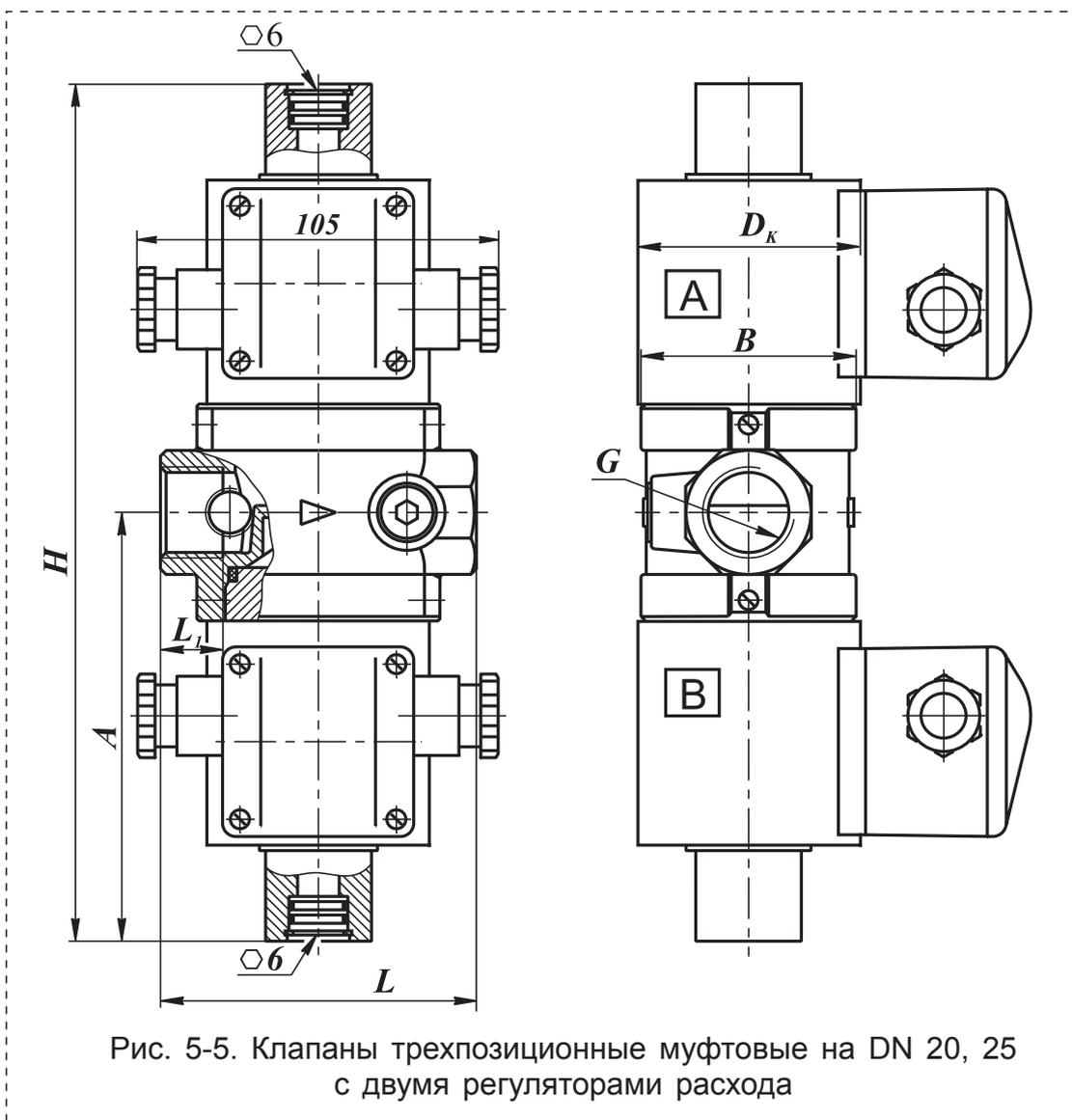
Рис. 5-5. Клапаны трехпозиционные муфтовые на DN 20, 25 с двумя регуляторами расхода
