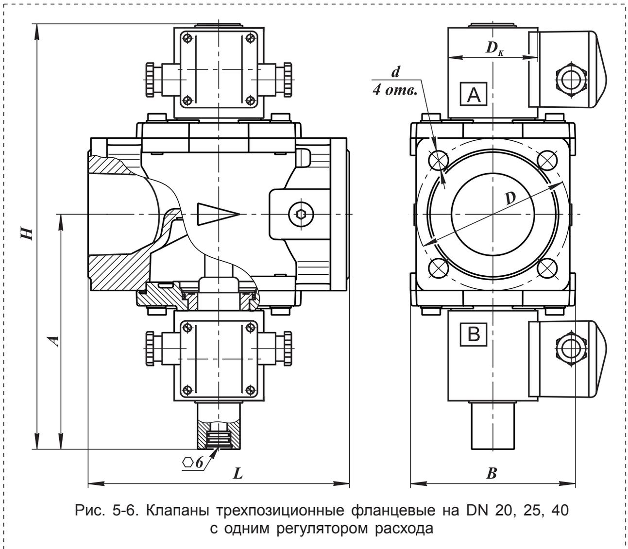
Рис. 5-6. Клапаны трехпозиционные фланцевые на DN 20, 25, 40 с одним регулятором расхода
