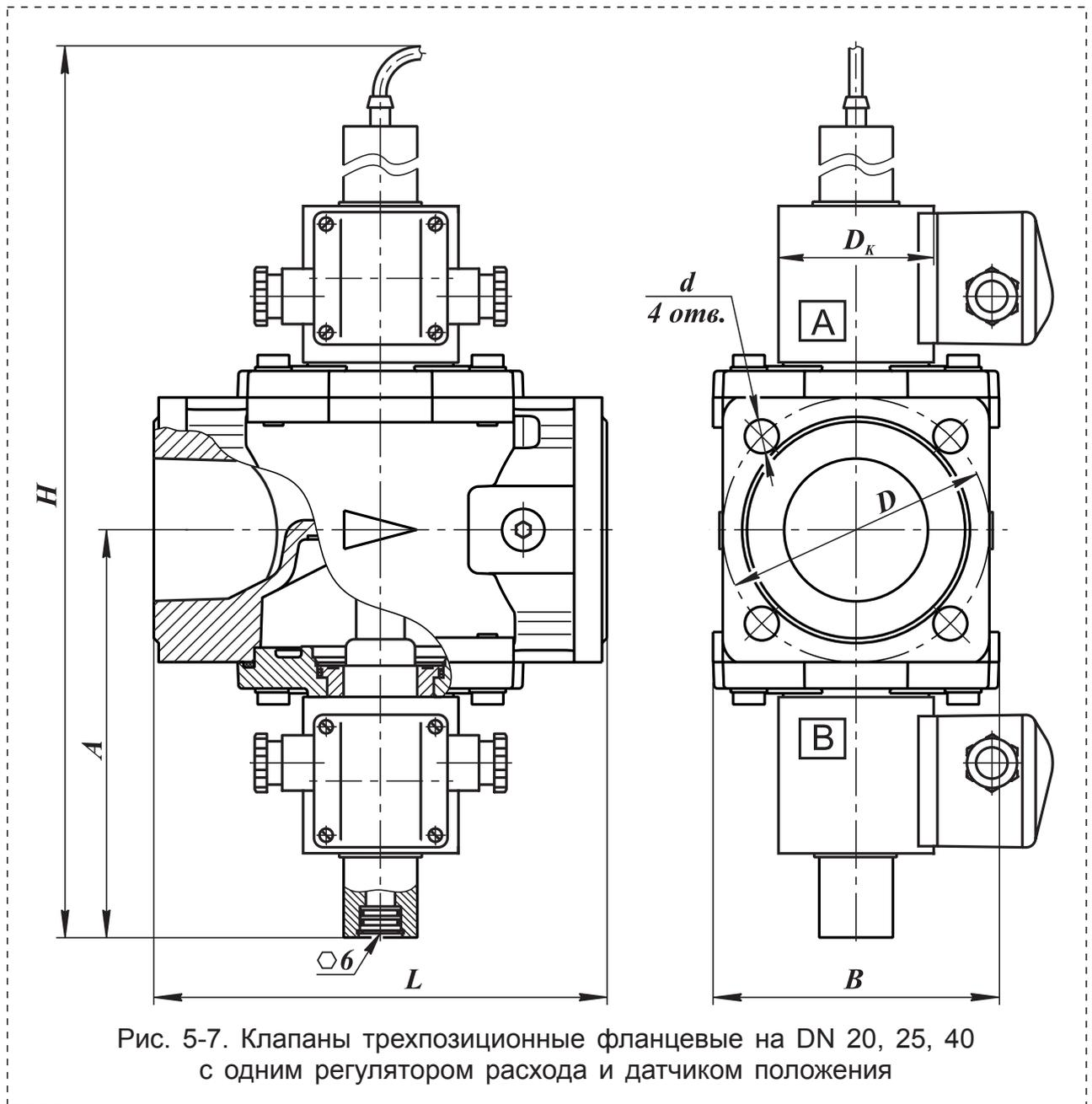
Рис. 5-7. Клапаны трехпозиционные фланцевые на DN 20, 25, 40 с одним регулятором расхода и датчиком положения
