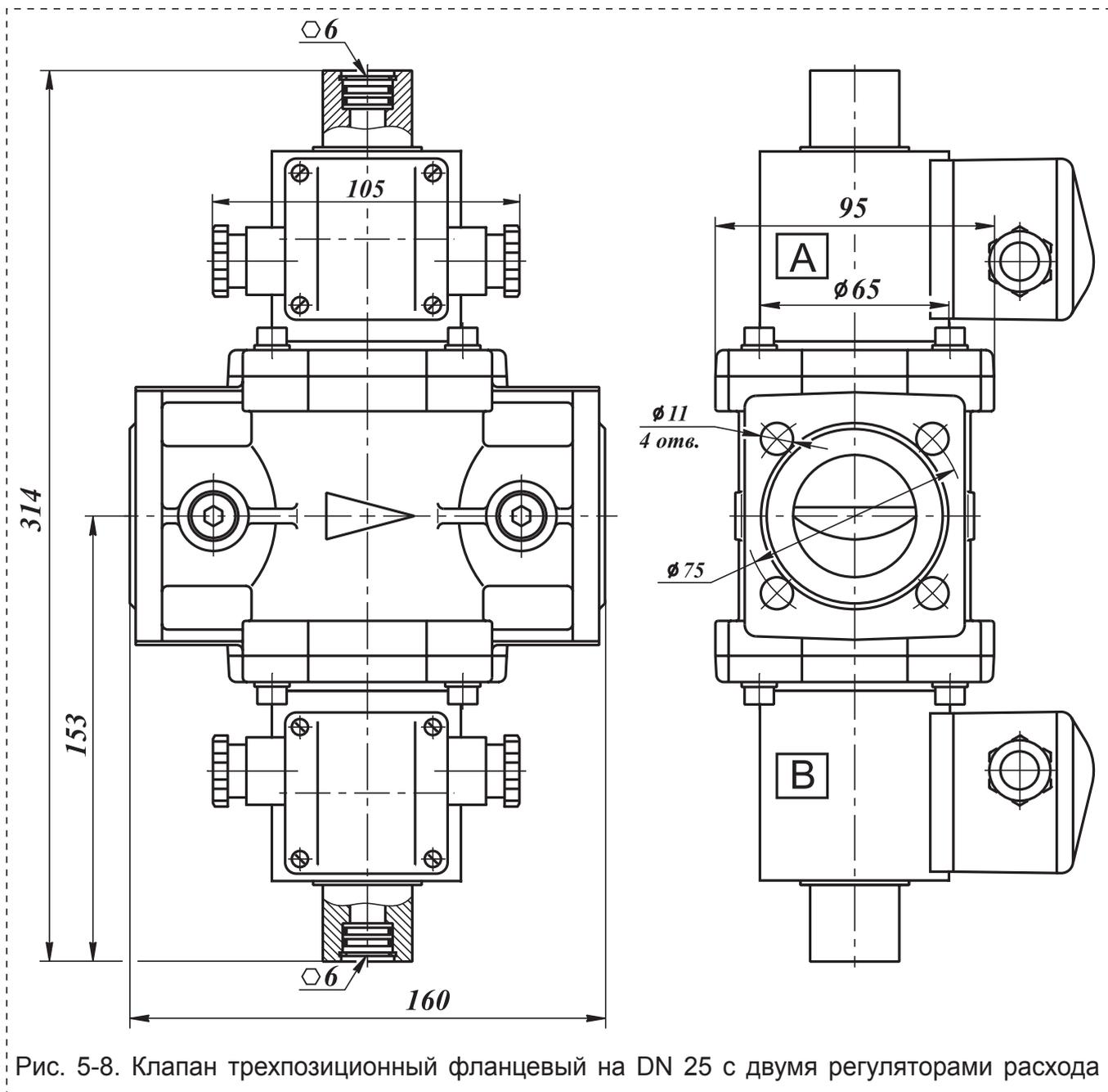
Рис. 5-8. Клапан трехпозиционный фланцевый на DN 25 с двумя регуляторами расхода
