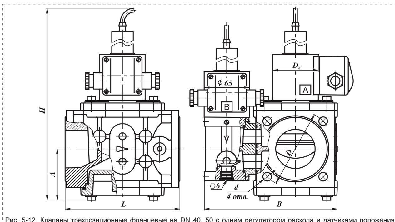
Рис. 5-12. Клапаны трехпозиционные фланцевые на DN 40, 50 с одним регулятором расхода и датчиками положения
