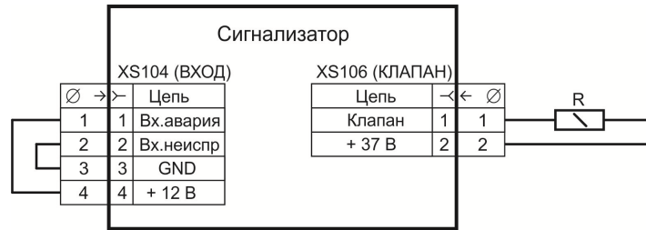
Рисунок Г.1 – Установка перемычек и имитатора клапана
