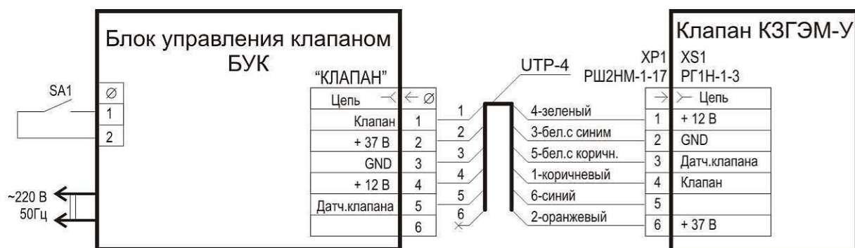
Типовая схема подключения клапана КЗГЭМ-У к блоку управления клапаном
