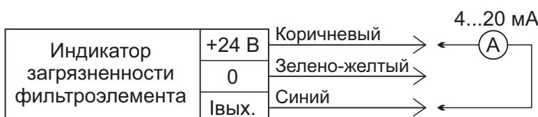
Рис. 9-30. Схема подключения индикатора, работающего от сети
