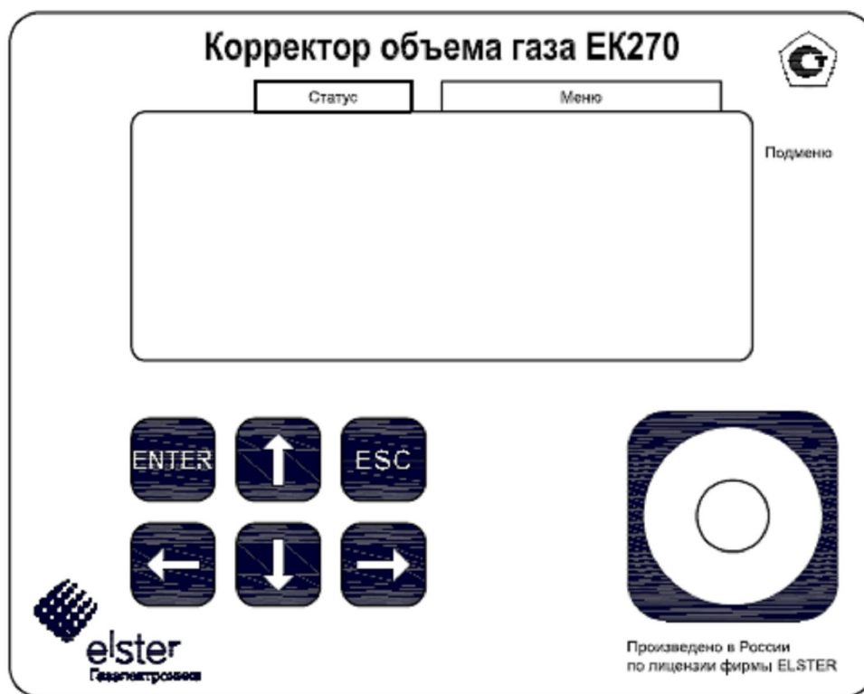
Рис.1. Внешний вид корректора EK270
